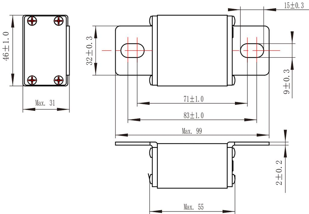
尺寸代码：00 额定电压：750Vdc
